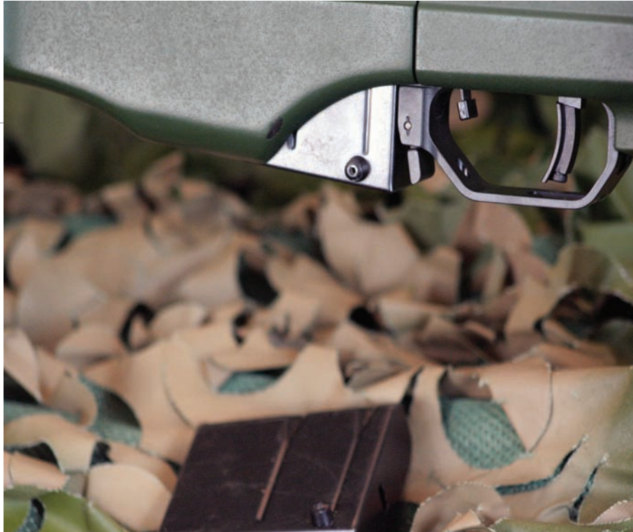
Механизам за окидање је пошћуно подесив по висини, дужини, углу и тежини окидања
